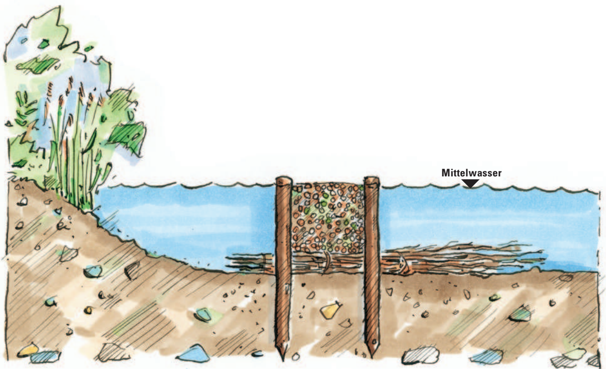
Abb. 4.44: Lahnung, Querschnitt
