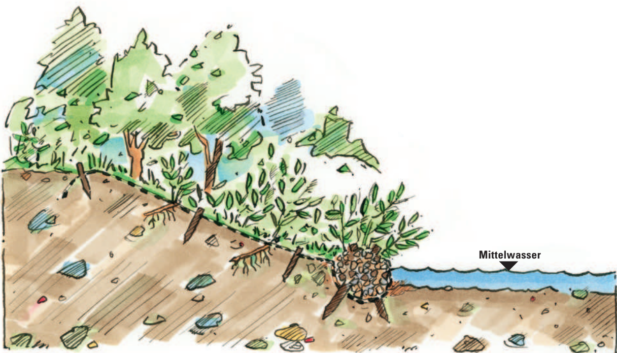
Abb. 4.40: Böschungsschutzmatte in Kombination mit Faschinen-Fußsicherung, Herstellungszustand
