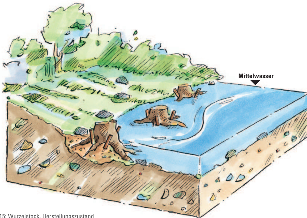
Abb. 4.15: Wurzelstock, Herstellungszustand
